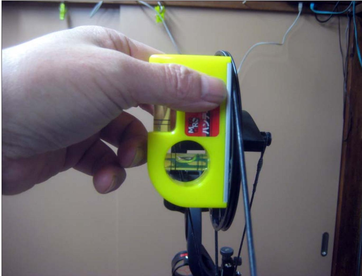
上下カムの垂直が調整が出来たら、レスト・サイトのセンター出しをしてからペーパーで簡単にチェック/調整します。
