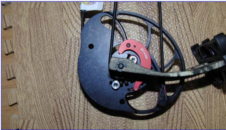
カムの形状はDriveよりややアクセントが大かという印象がありますが、目立つのがストッパーの位置で従来のように外周部ではなくかなり中にセットされています。モジュールは2011年モデルのカムのように2個のモジュールを交換して1/2インチ刻みのドロレングスを調整するのではなく1個のモジュールでできるようです。モジュール番号は80143RB。
