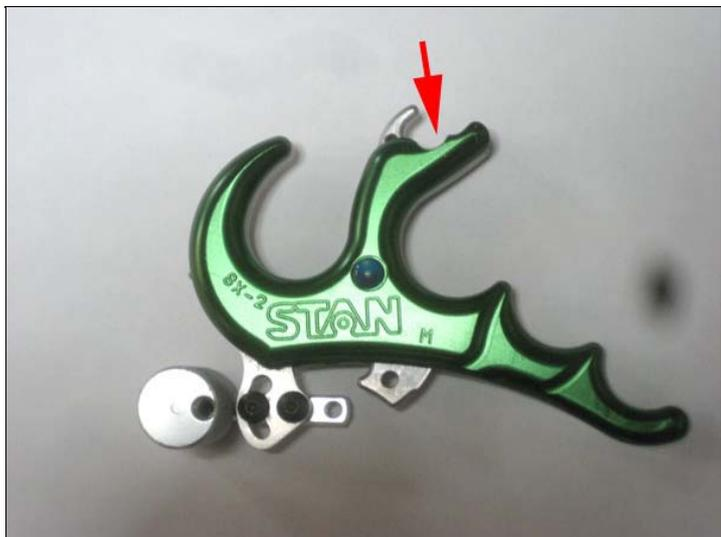
結局、ループの太さを削るわけにもゆかず、そのままではテストにはならないので、**Stan**のジョーの受け口の矢印の部分をやすりで削りました。
