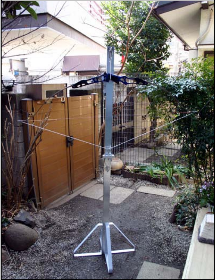
ドローイングジグによるリムバランスの調整風景
