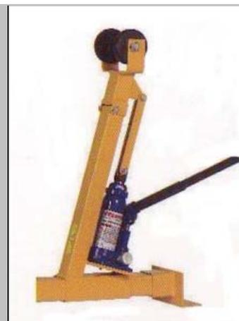
昨年辺りから、片側のアームパーツを油圧ジャッキつきのものに交換することでパラレルリムに対応しようとしていましたが、PSEのXタイプのような極端にリムが短いモデルには対応不可能でした。
