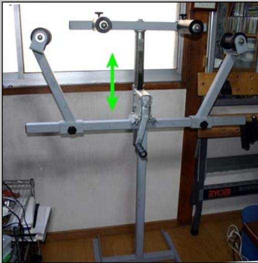
左は従来最も安全とされてきた、ギア方式のボウプレスなのですが、図のようにハンドルを押さえるサポートアームが上下するだけなので、パラレルリムのようにリムが寝ている(ボウプレス上では立っている)モデルではリムが滑って抜けてしまう可能性があります。
