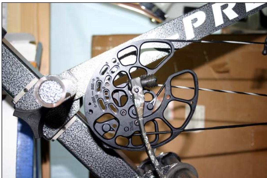
ところで、Mach-Xの平行リムは極端に短く、しかもホイールとアイドラーがかなり大型なので通常のボウプレスでは使用できません。平行リムに対応して製作されているSure-LocのX-Pressでも上の写真の通りの状態なのでApple社のものでは完全にアウトです。PSEが推奨するボウプレスは存在するらしいのですが、入手ルートが明確にされていません。
