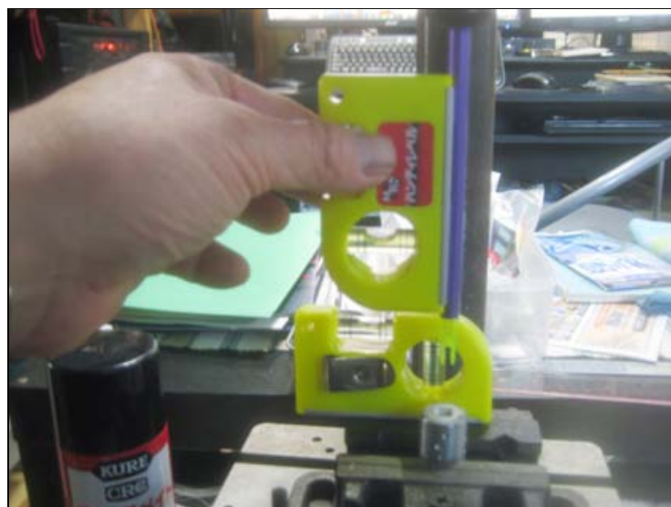
ドリル刃と固定台のセットはこうにして水平/垂直を出しました。 最終的にはレシーバーの設置も水平にする必要があります。
