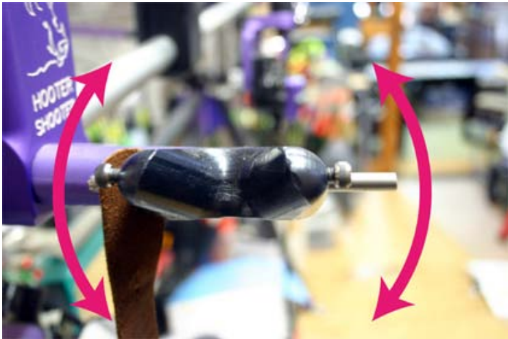
Hooter Shooterではローリング方向に調整・固定が可能なため垂直だしなどの用途に有効です。
