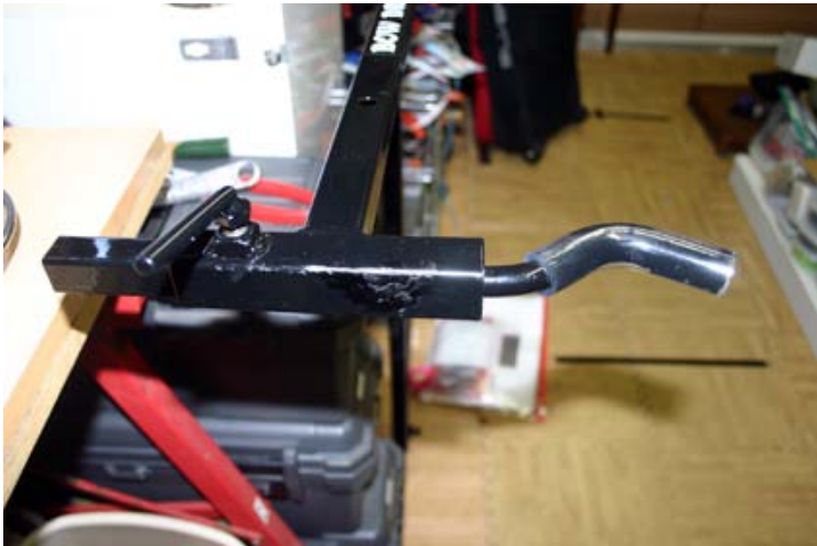
今回のツールではピボットサポート部分固定されているためローリング方向に調整できません。
