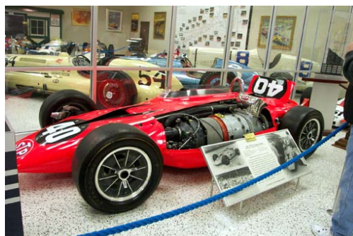
かつてインディに参戦したタービーカー (ヘリコプター用タービンを搭載したもの)
