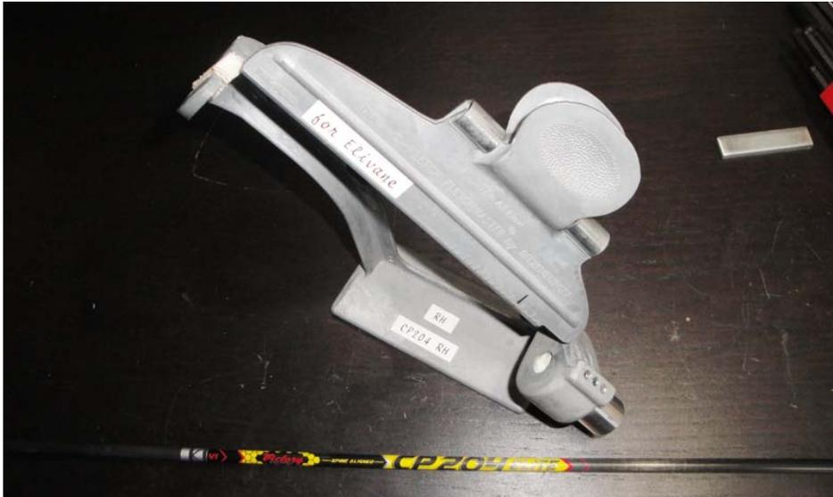
ヴェインをきれいに等間隔に貼るにはフレッチャーのチューニングが必要です。特にアローを受けるVカット部分の精度はフレッチングの精度を左右します。特に今回ベースとする Bitzenburger のフレッチャーはハンティングアローの作成をメインとしているためこのカット部分は21径以上の太いアルミアローを前提としているためそのまま使用した場合には、レシーバーを回すごとにアローの方向にずれが生じきれいな等間隔のフレッチングは出来ません。カーボンアローが主流となりアローシャフトの径がより細くなっている現在ではこの部分の補正は大変に重要となります。
